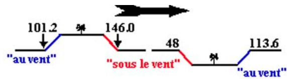
figure 6 : influence de la direction du vent et du profil en travers sur les dépôts de plomb ( \mu\text{g}/\text{m}^2/\text{jour} ) Somme des valeurs à 5, 20 40, 80 m sur des parties en remblais et en déblais. A31 Sud – 42 000 Véh/j – Février 98.
