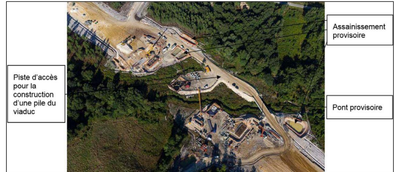
Figure 9 – Illustration d'une zone de travaux à proximité d'un viaduc
