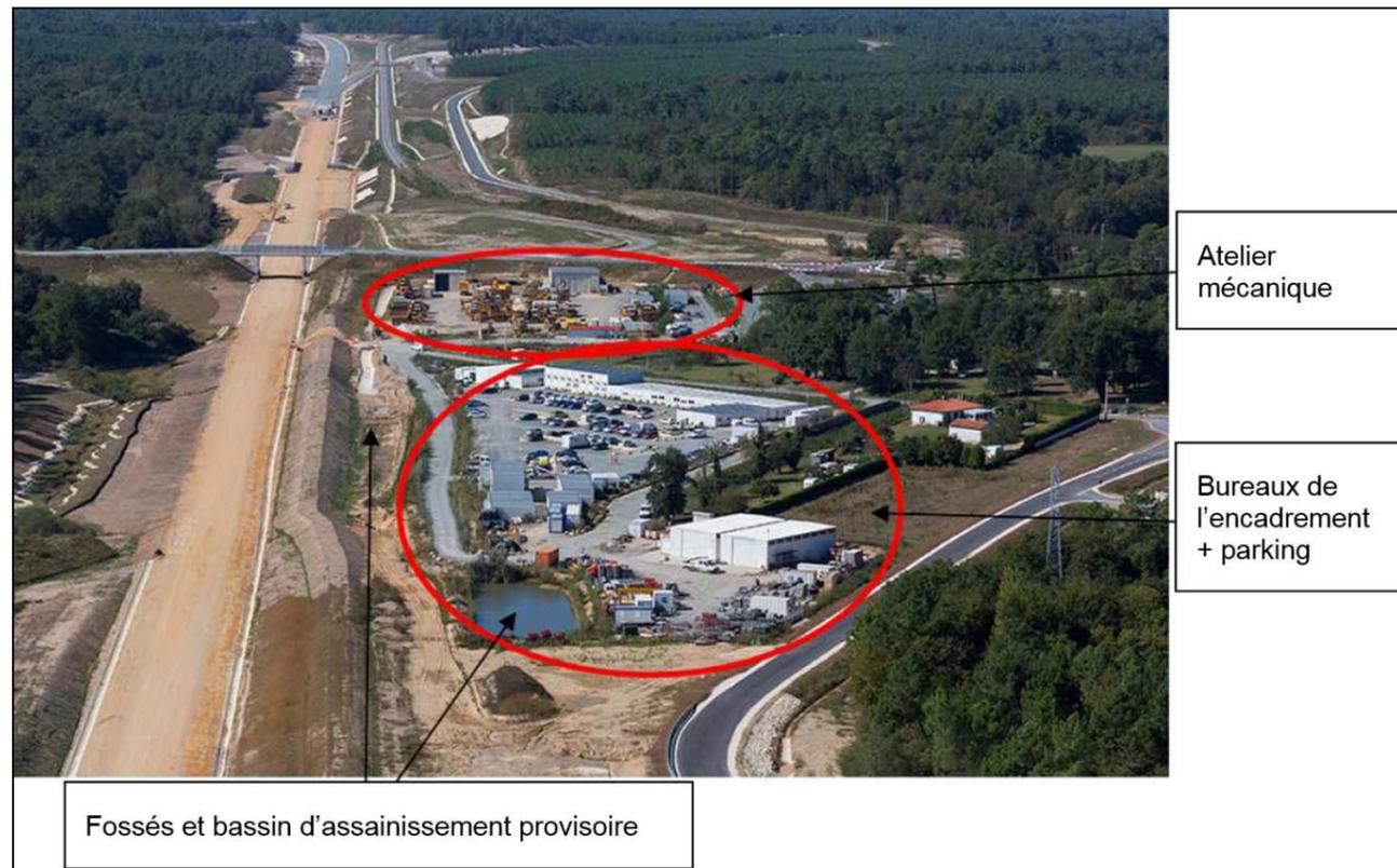
Figure 6 – Illustration d'une installation de chantier principale
